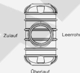
\* Plano de medidas Depósito Erdtank 1.000L sin cubierta. Para altura total con cubierta telescópica mirar tabla datos técnicos más abajo.
